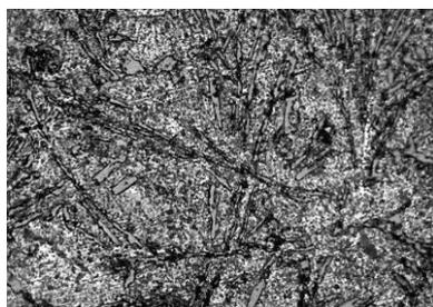
Рис. 2. Структура сплава Д16 после закалки
